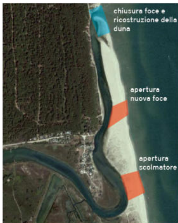
Figura 2. Schema di intervento di sistemazione della foce del Torrente Bevano. Rappresentazione schematica delle principali aree di intervento e delle opere realizzate nel 2006 (da Montanari e Marasmi, 2013).
